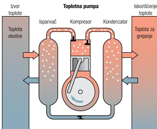
Toplotne pumpe vazduh/voda crpe energiju iz okолног vazduha, pri čemu ovaj izvor energije nije na potreboj temperaturi. Tek toplotna pumpa podiže energiju na potreban temperaturski nivo.
